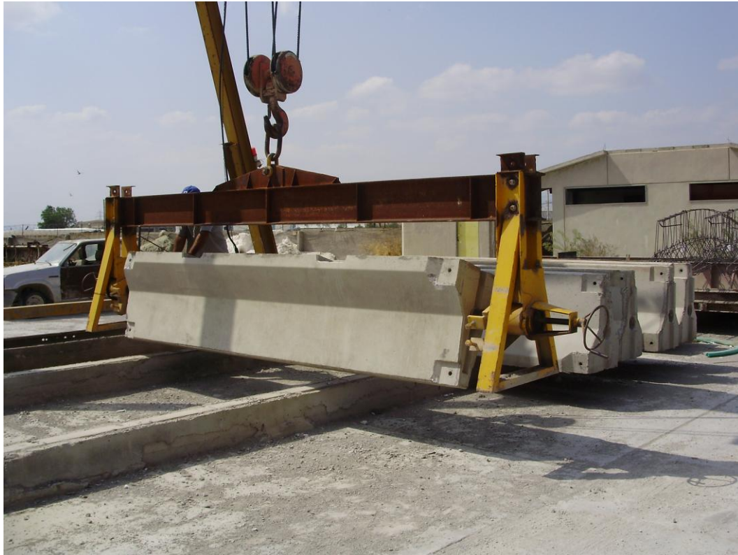
Σχήμα 5. Έτοιμο ΠΣΑ περιστρέφεται με μια ειδική διάταξη
