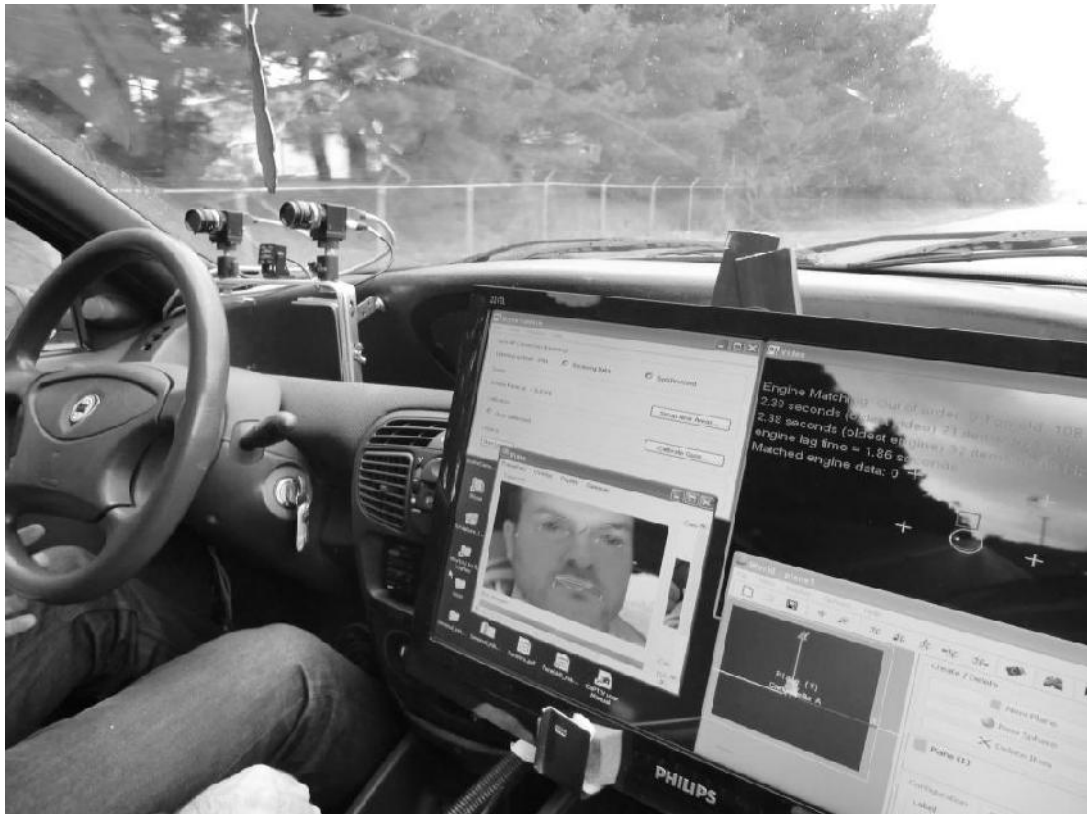
Εικόνα 2.2: Σύστημα παρακολούθησης και καταγραφής ματιών και κεφαλής οδηγού Facelab
